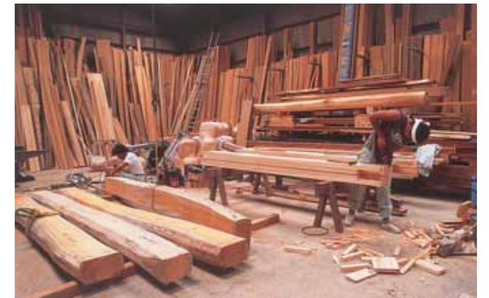
常時きざみ加工をしているなんば建築工房内の作業場
